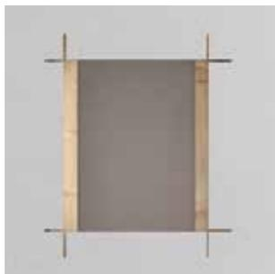
Cortar un agujero en la pared e instala dos tablas de madera. (dimensiones: ver ficha técnica)
