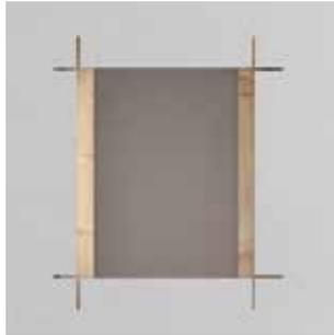
Cortar a 225 x 192 x 65 mm agujero rectangular en la pared e instalar 2 tablas de madera.
