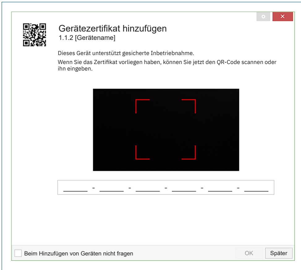
Abbildung 4: Inbetriebnahme mit ETS – Sicherheit: Gerätezertifikat hinzufügen
